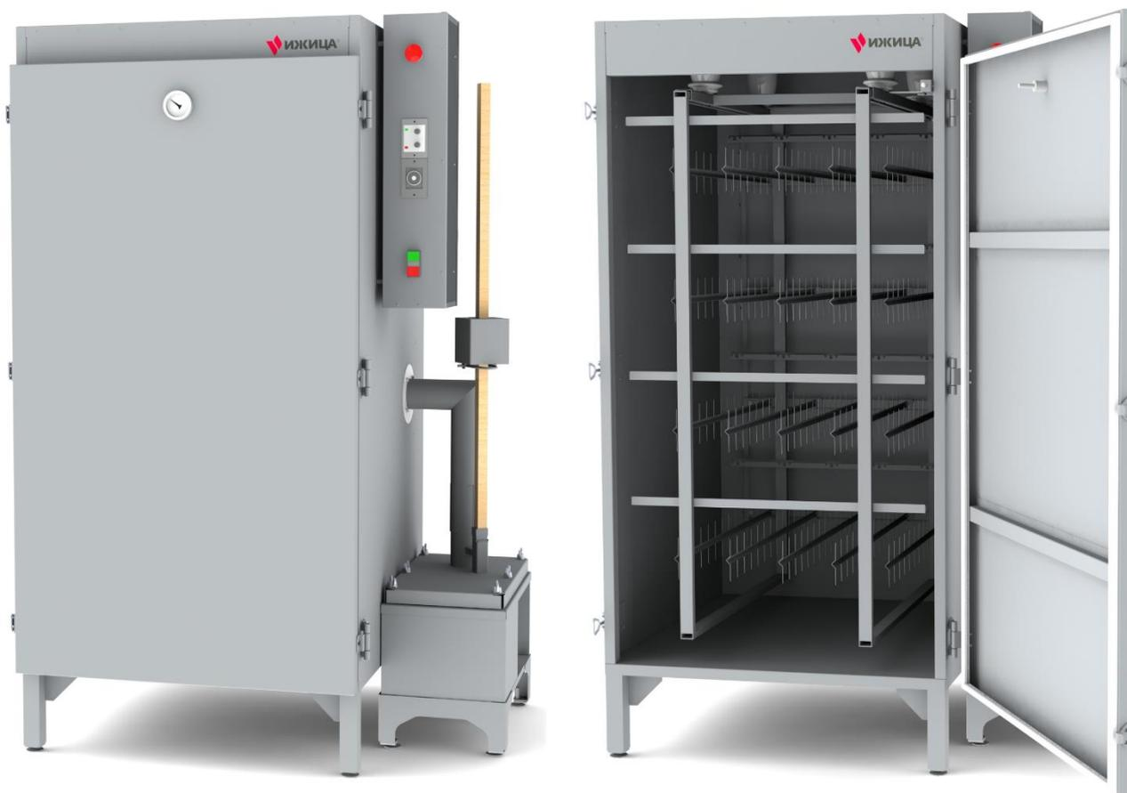
Ижица-1200МЗ – это коптильня для современного электростатического холодного копчения. В ней используется эффект электронного ветра, который подхватывает дым и направляет его на продукт. Благодаря этому копчение занимает всего 1,5 часа вместо 8 часов при традиционном копчении.
