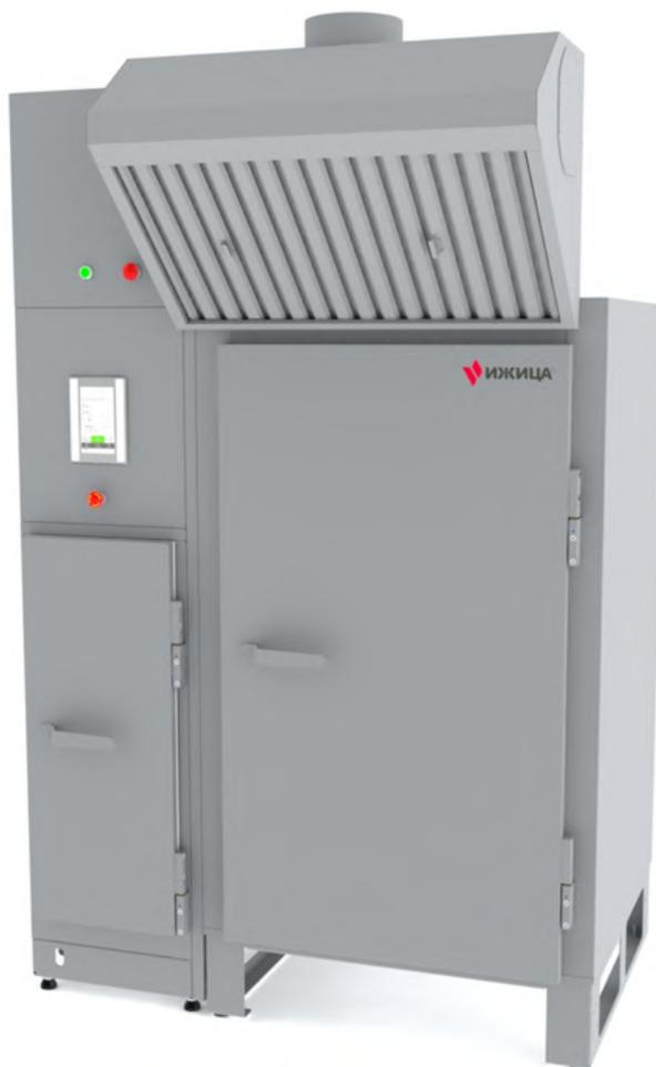
Ижица-1200М4-А – это автоматизированная коптильня для современного электростатического холодного копчения. В ней используется эффект электронного ветра, который подхватывает дым и направляет его на продукт. Благодаря этому копчение занимает всего 1,5 часа вместо 8 часов при традиционном копчении.
