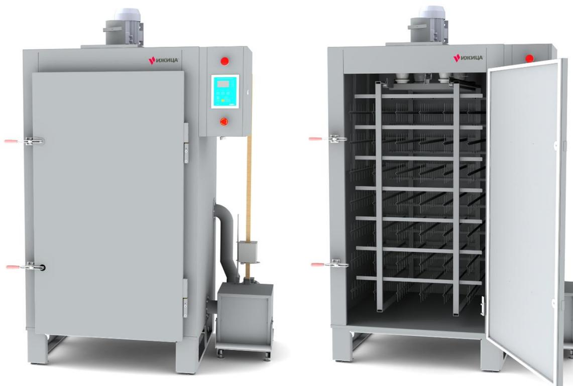
Ижица-1200М4 – это коптильня для современного электростатического холодного копчения. В ней используется эффект электронного ветра, который подхватывает дым и направляет его на продукт. Благодаря этому копчение занимает всего 1,5 часа вместо 8 часов при традиционном копчении.
